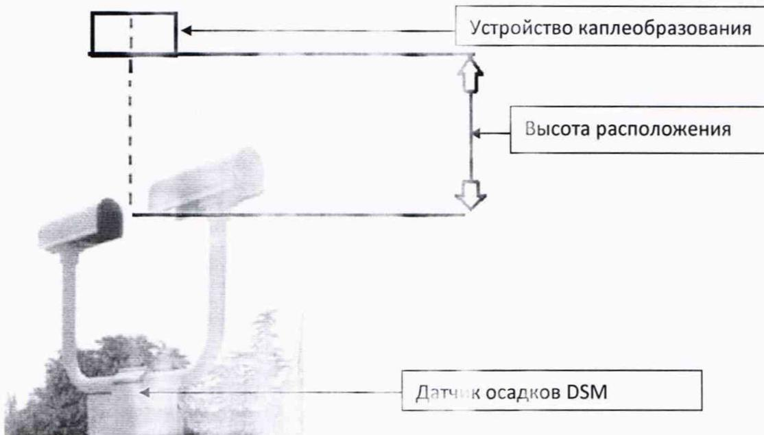
Рисунок 1 – Схема расположения устройства каплеобразования
