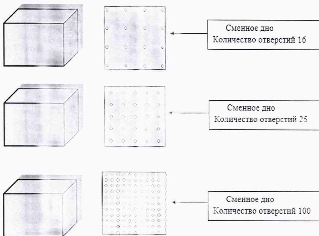
Рисунок 2 – Общий вид устройств каплеобразования
