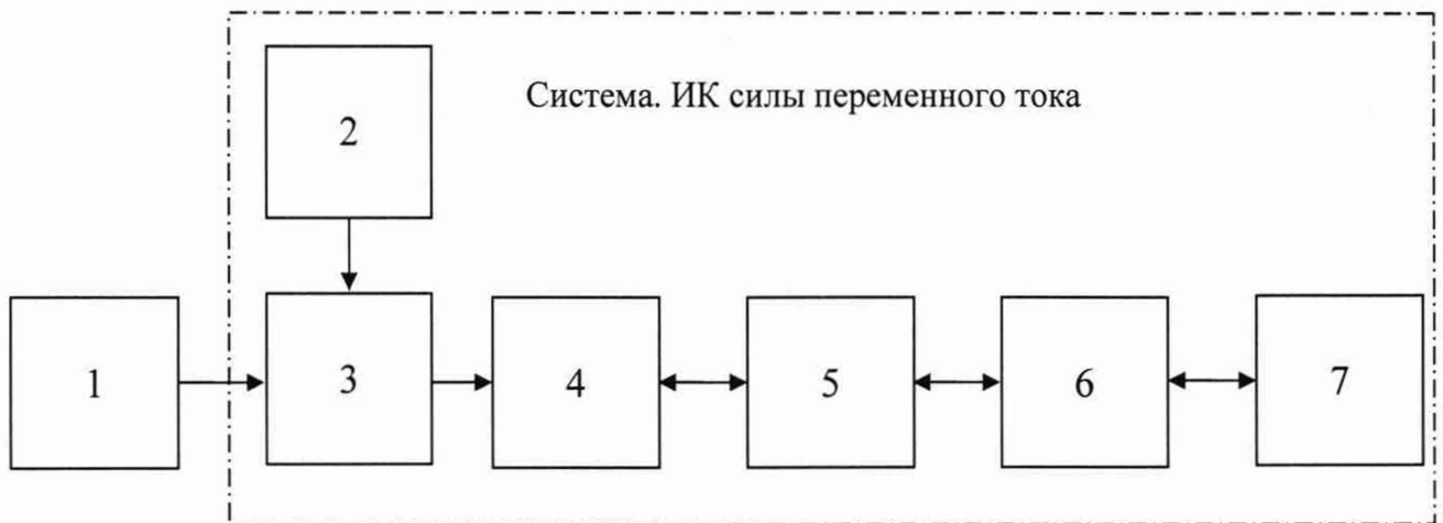
Рисунок Б.5.1 – Функциональная схема поверки ИК напряжения переменного электрического тока
