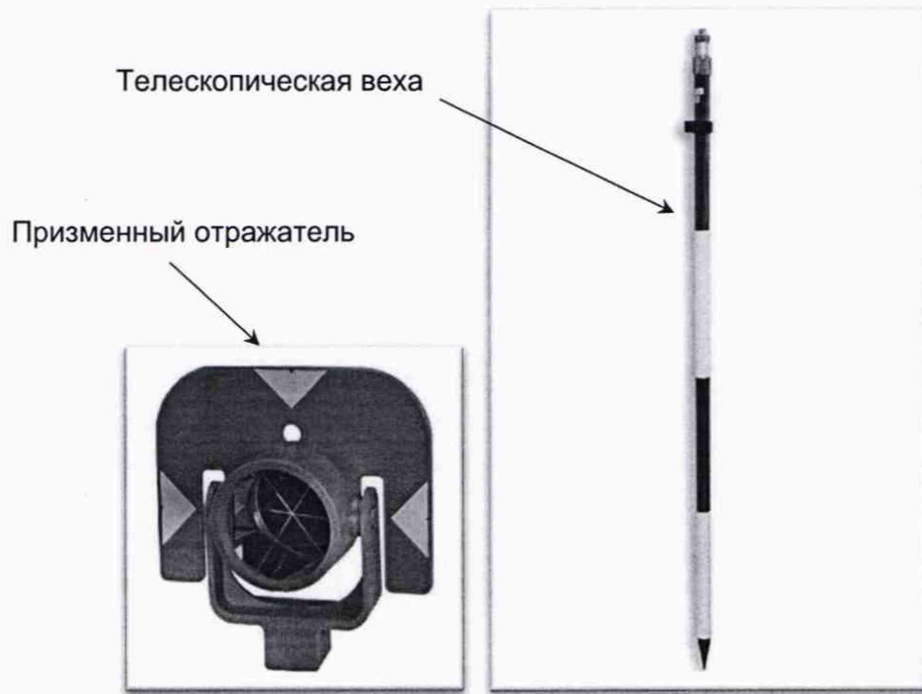
Рисунок А.1 – Веха телескопическая с призмным отражателем
