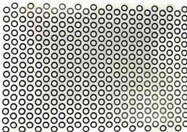
Рисунок 1 - Светоотражающие не кодированные метки.
