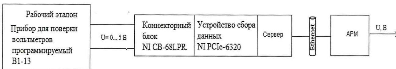
Рисунок 9 – Схема Определеение погрешности измерений параметров вибрации
