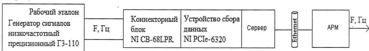
Рисунок 5 – Схема проверки погрешности ИК объемного расхода топлива
