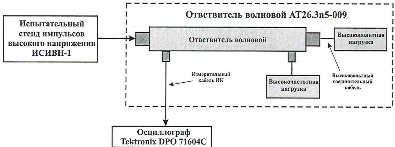
Рисунок 3 – Схема соединений при определении максимального измеряемого значения амплитуды импульсов напряжения ответвителя
