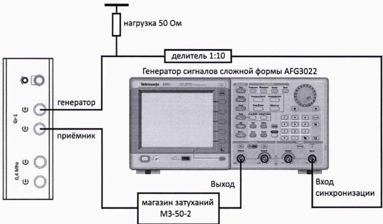
Рисунок 2 – Схема соединения для определения абсолютной погрешности измерений отношений амплитуд сигналов на входе приемника
