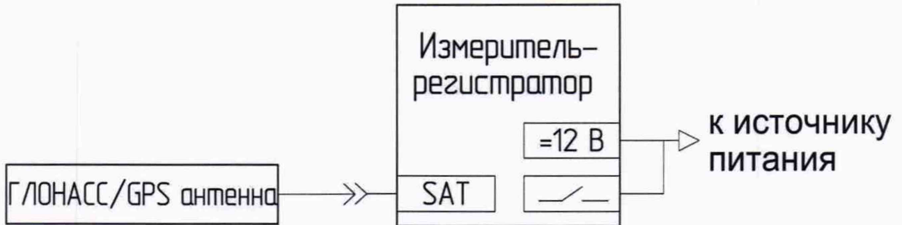
Рисунок 1 — Схема подключения регистратора для проверки работоспособности
