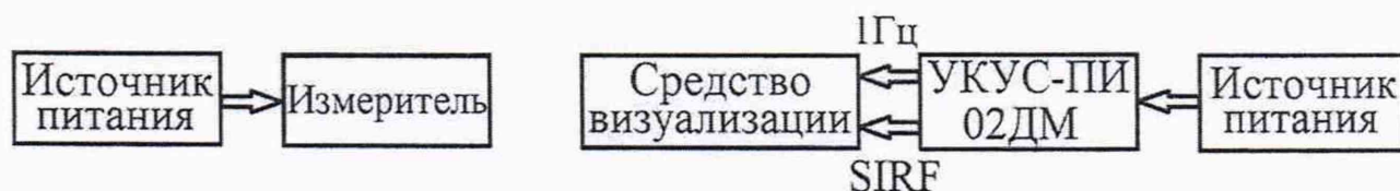
Рисунок 1 – Схема по определению абсолютной погрешности синхронизации времени
