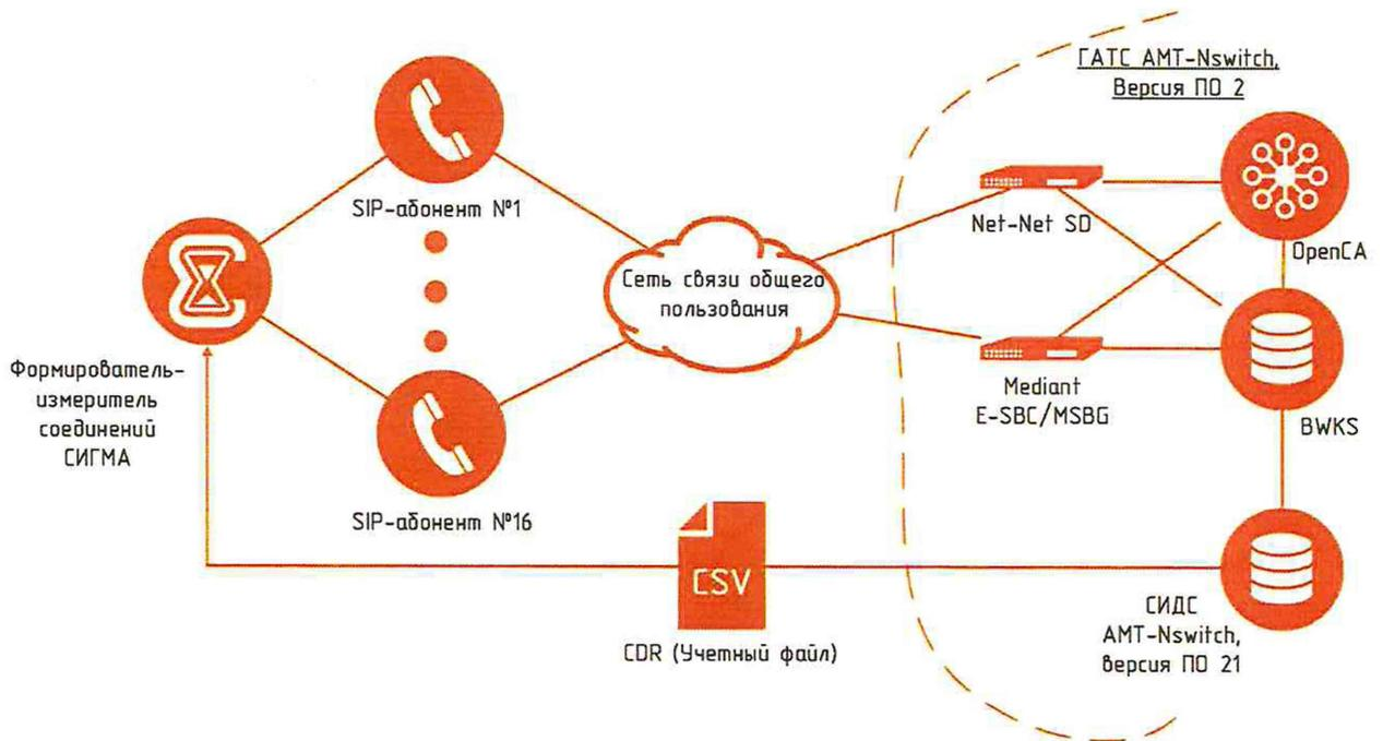
Рисунок 2 – Схема поверки СИДС
