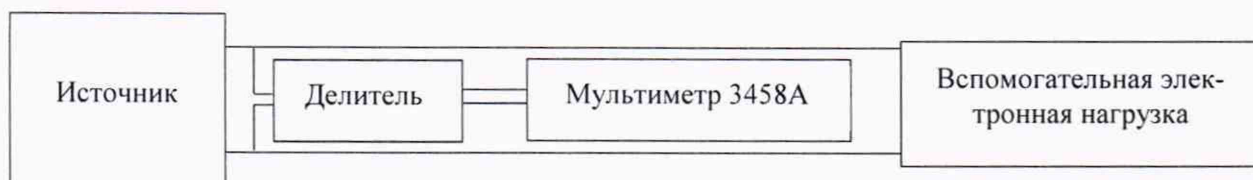
Рисунок 2 – Структурная схема определения абсолютной погрешности воспроизведений/измерений напряжения постоянного тока (св. 1000 В)
