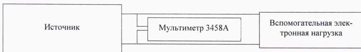
Рисунок 1 – Структурная схема определения абсолютной погрешности воспроизведений/измерений напряжения постоянного тока (от 0 до 1000 В включ.)
