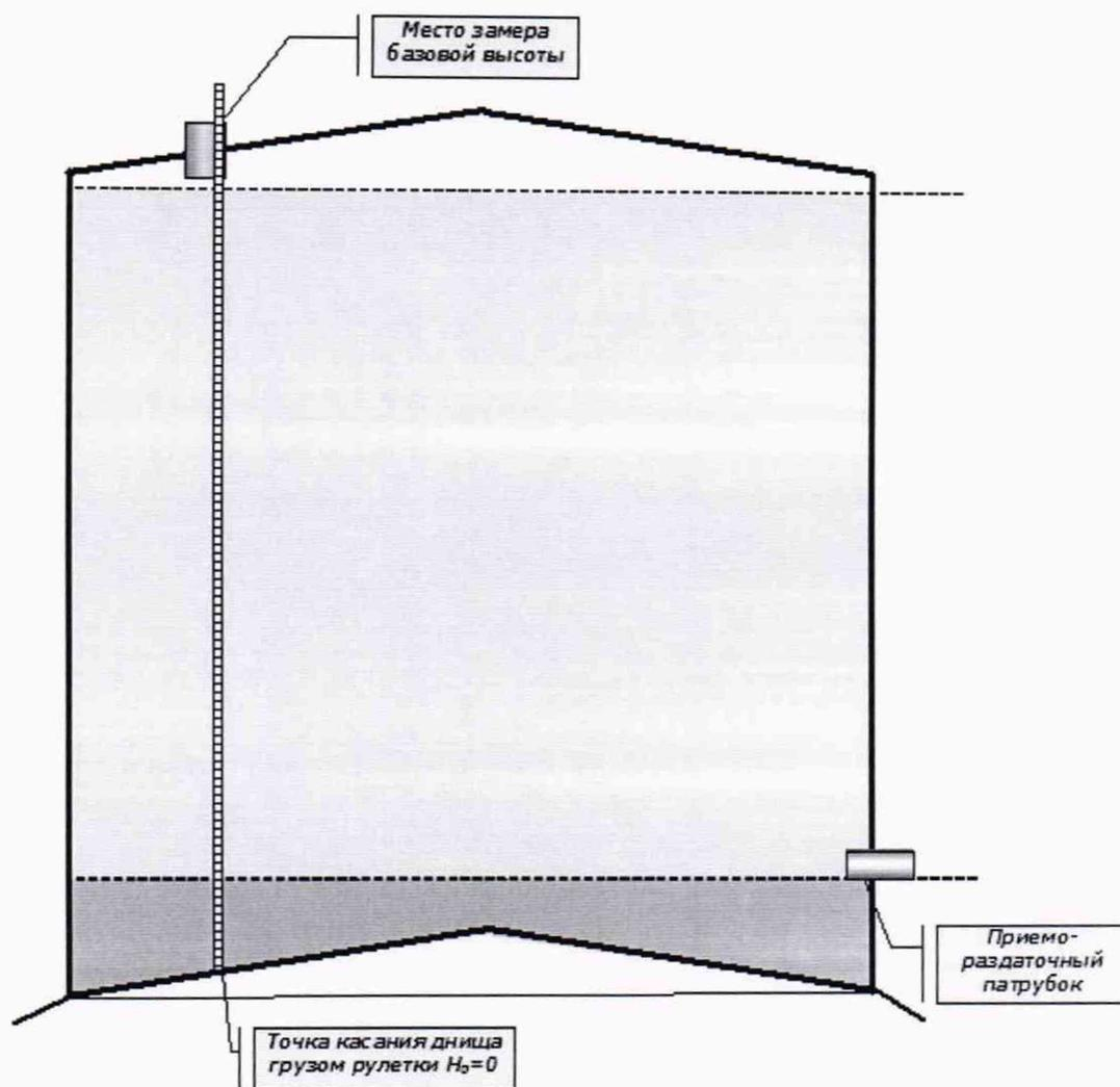
Рисунок А.1. Схема измерения базовой высоты резервуара
