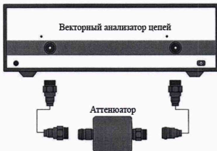
Рисунок 2 - Схема измерений КСВН входа и выхода аттенюатора
