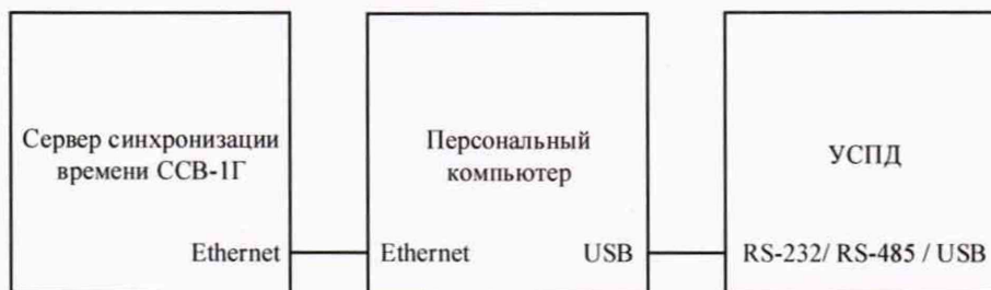
Рисунок 1 – Схема подключения приборов при определении основной абсолютной погрешности хода внутренних часов в автономном режиме за сутки
