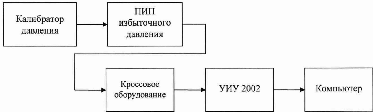
а) Схема определения метрологических характеристик комплектным способом
