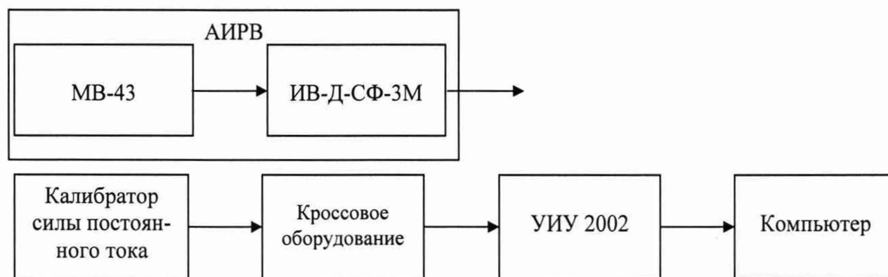
Рисунок 9 - Схема определения метрологических характеристик ИК виброскорости
