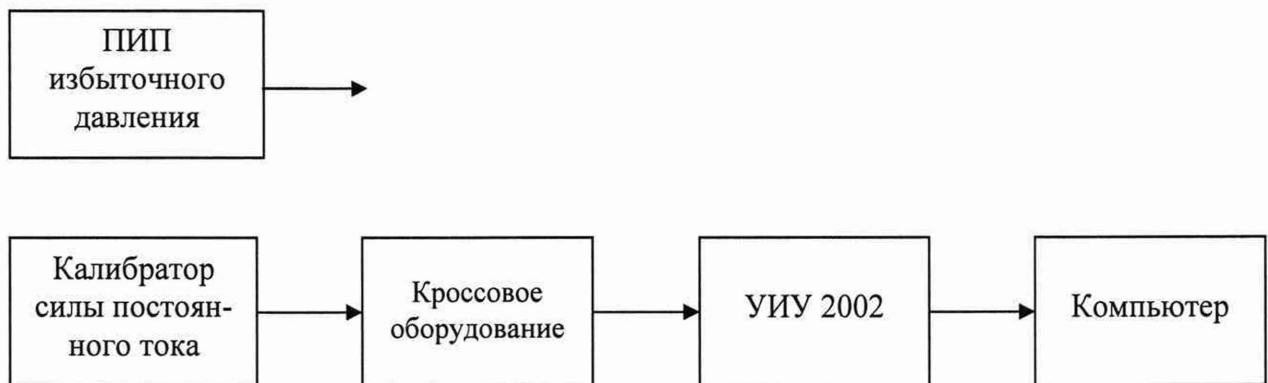
б) Схема определения метрологических характеристик поэлементным способом
