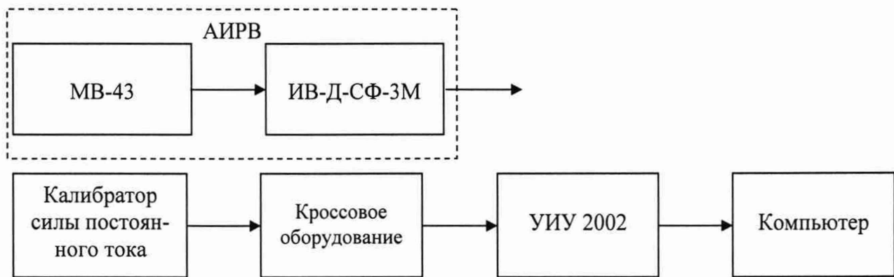
Рисунок 10 - Схема определения метрологических характеристик ИК силы постоянного тока, соответствующей значениям виброускорения
