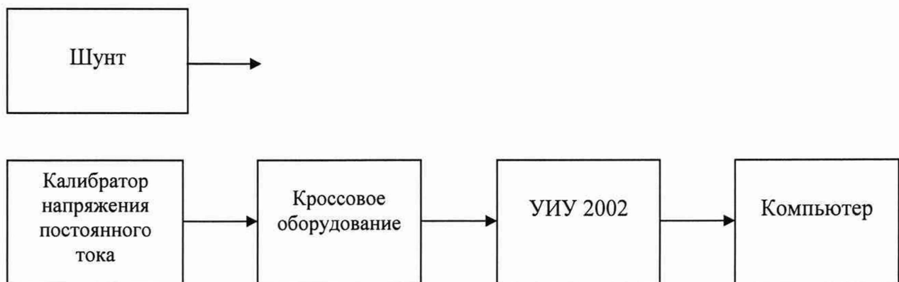
Рисунок 13 - Схема определения метрологических характеристик ИК силы постоянного тока (с шунтами)
