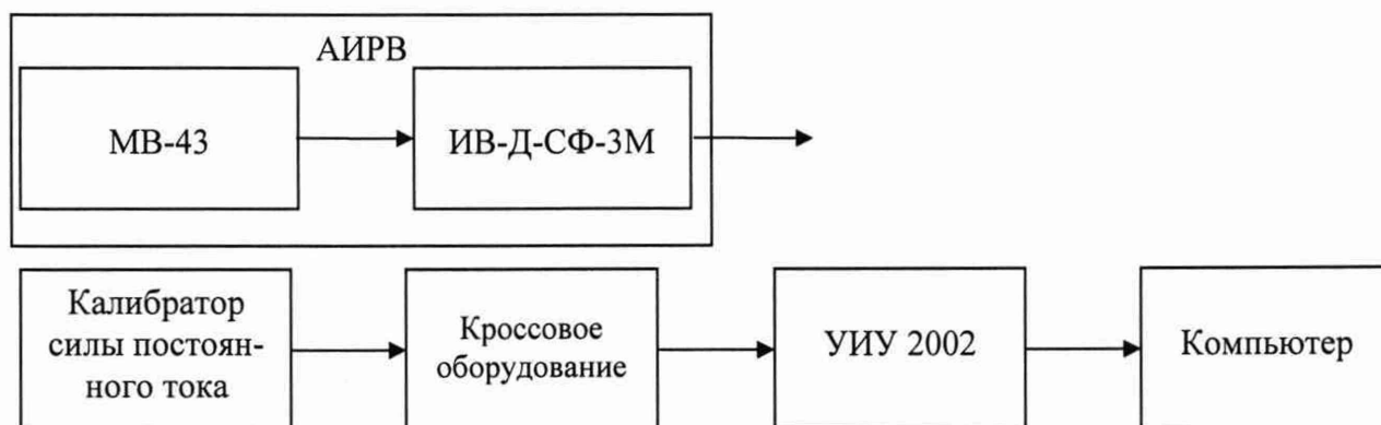
Рисунок 11 - Схема определения метрологических характеристик ИК виброускорения
