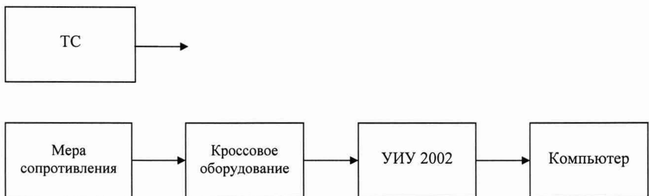
б) Схема определения метрологических характеристик поэлементным способом
