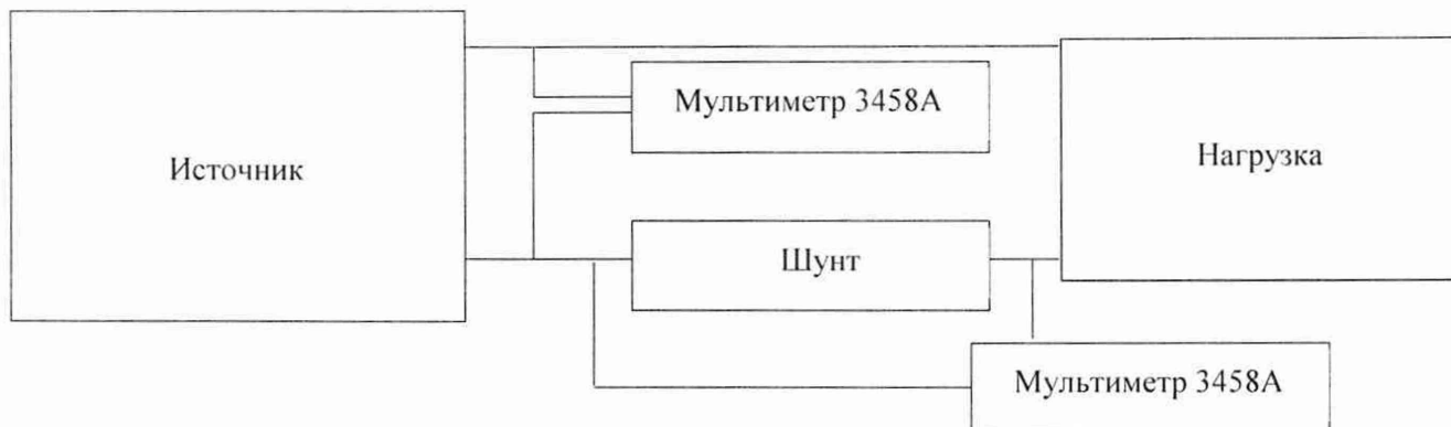
Рисунок 3 - Структурная схема определения абсолютной погрешности измерений/установки электрической мощности постоянного тока
