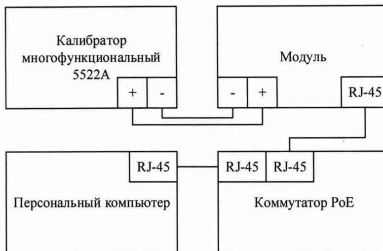
Рисунок 1 – схема определения приведенной (к верхнему пределу измерений) погрешности измерений силы постоянного тока
