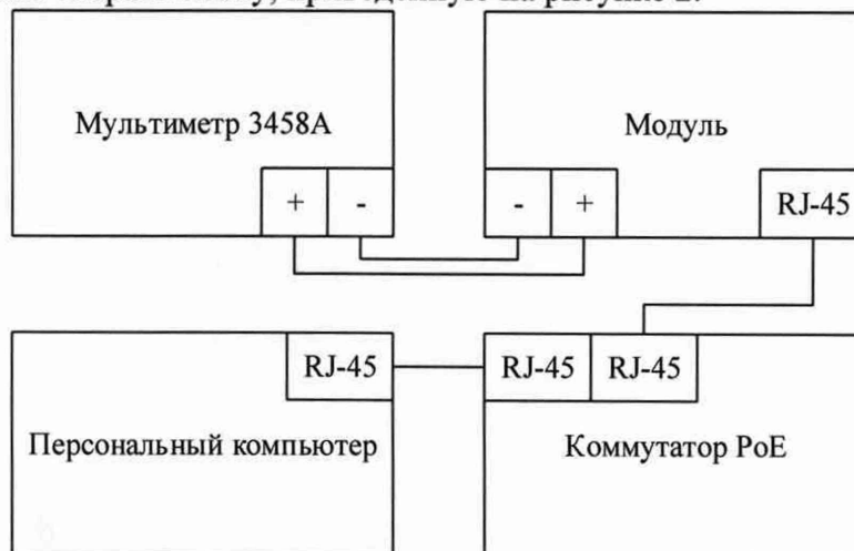
Рисунок 2 – схема определения приведенной (к верхнему пределу воспроизведений) погрешности воспроизведений силы постоянного тока
