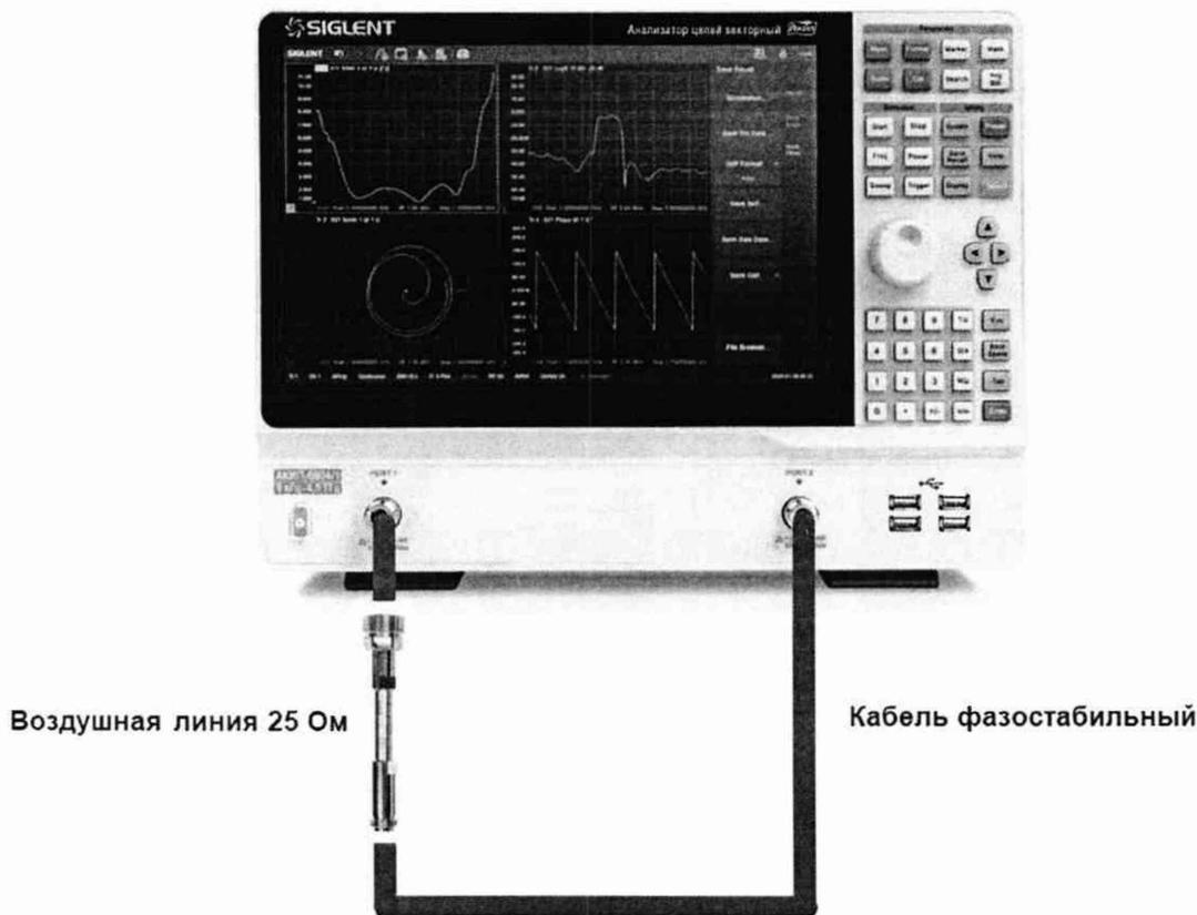
Рисунок 6 – Схема соединения приборов для определения погрешности измерения S-параметров
