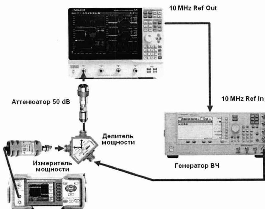
Рисунок 4 – Схема соединения приборов для измерения уровня мощности анализатором цепей с аттенюатором
