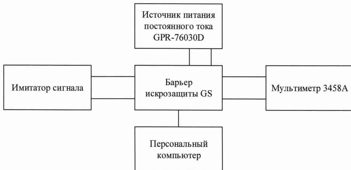
Рисунок А.1 – Схема определения основной приведенной (к верхнему пределу диапазона входного сигнала) погрешности преобразований Имитатор сигналов - Калибратор многофункциональный и коммуникатор ВЕАМЕХ МС6 (-R), Мера электрического сопротивления постоянного тока многозначная МС3070М-1, Генератор сигналов специальной формы АКИП-3409/1
