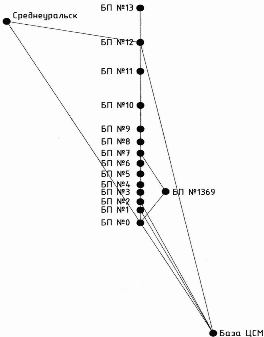
Рисунок 1 – Схема расположения пунктов полигона Свердловский
