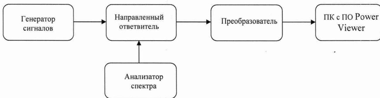
Рисунок 4 – Схема определения погрешности измерений мощности, модулированных сигналов
