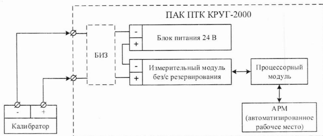
Рисунок А.2 – Функциональная схема при проверке каналов измерений силы постоянного тока для подключения к токовым датчикам (пассивным)
