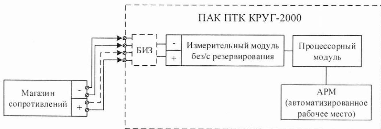
Рисунок А.3 – Функциональная схема при проверке каналов измерений электрического сопротивления и температуры с помощью внешних термометров сопротивлений по трех- или четырехпроводной схеме
