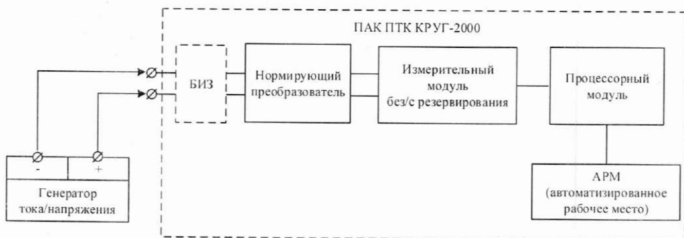
Рисунок А.6 – Функциональная схема при проверке каналов с нормирующими преобразователями
