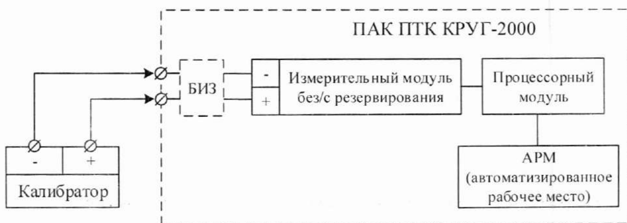
Рисунок А.1 – Функциональная схема при проверке каналов измерений силы постоянного тока для подключения к токовым датчикам (активным), напряжения постоянного тока и температуры с помощью внешних термопар
