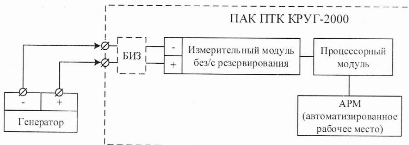
Рисунок А.4 – Функциональная схема при проверке каналов импульсного ввода
