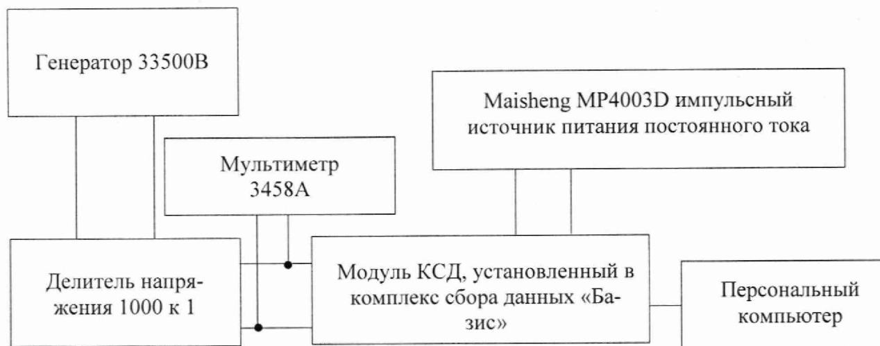
Рисунок 2 – Схема подключений для определения приведенной, к диапазону преобразований, погрешности преобразования амплитудного значения напряжения переменного тока для модуля КСД/А06 и КСД/А07
