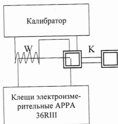
Рисунок 2 – Схема подключения при определении относительной погрешности преобразований
