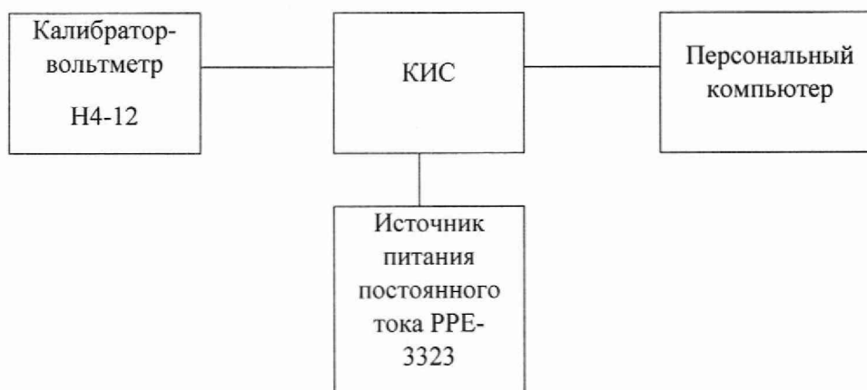
Рисунок 1– Схема подключения для определения приведенной погрешности систем КИС-500
