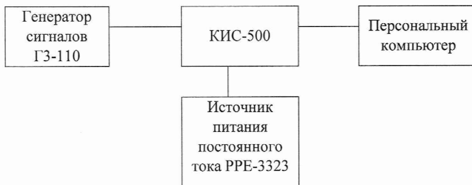
Рисунок 2– Схема подключения для определения приведенной погрешности систем КИС-500 на диапазоне измерений от 200 Гц до 8000 Гц
