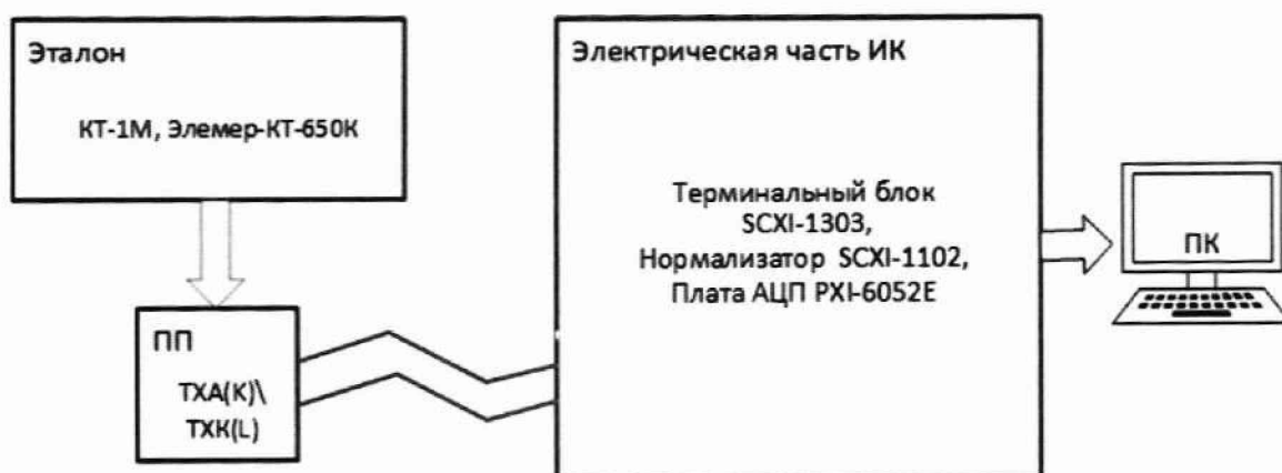
Рисунок 7 – Схема поверки ИК температуры газообразных сред с ПИП термоэлектрического типа ТХА, ТХК комплектным способом
