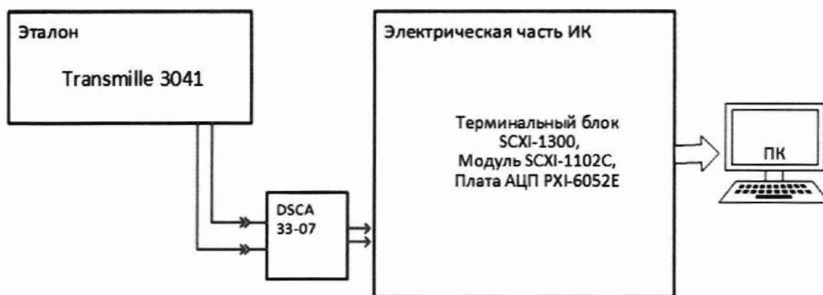
Рисунок 13 – Схема поверки ИК силы тока в цепи нагрузки генератора переменного тока
