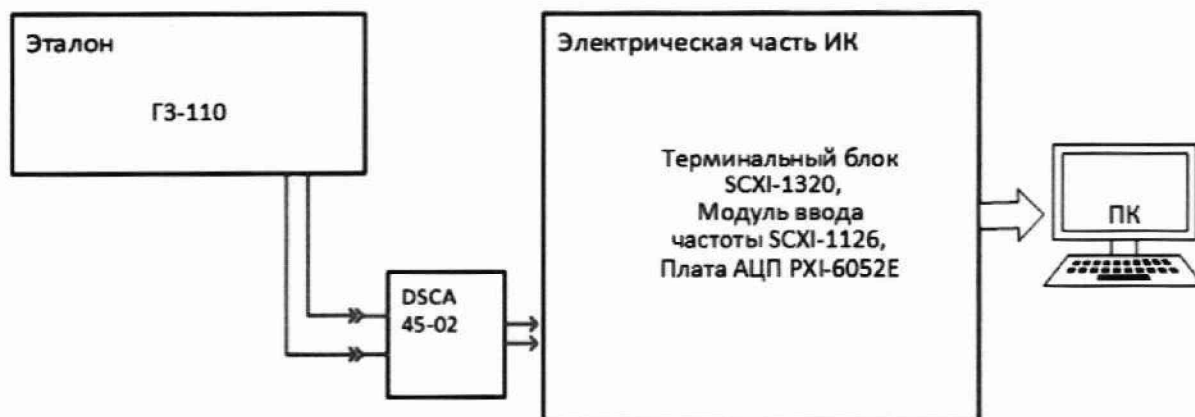
Рисунок 12 – Схема поверки ИК частоты тока на клеммах контактора нагрузки генератора переменного тока
