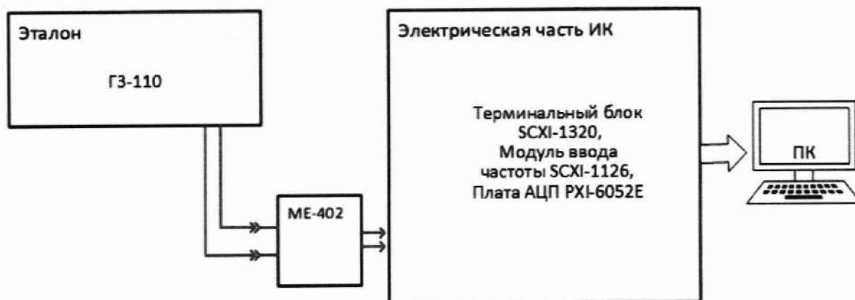
Рисунок 3 – Схема поверки ИК частоты переменного тока, соответствующей частоте вращения роторов
