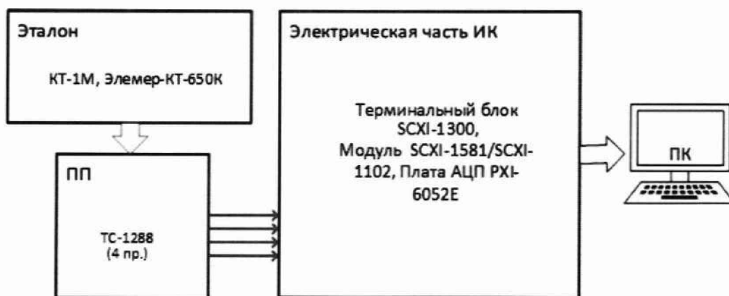
Рисунок 9 – Схема поверки ИК температуры жидких и газообразных сред с ПИП терморезистивного типа (термометров сопротивления) комплектным способом
