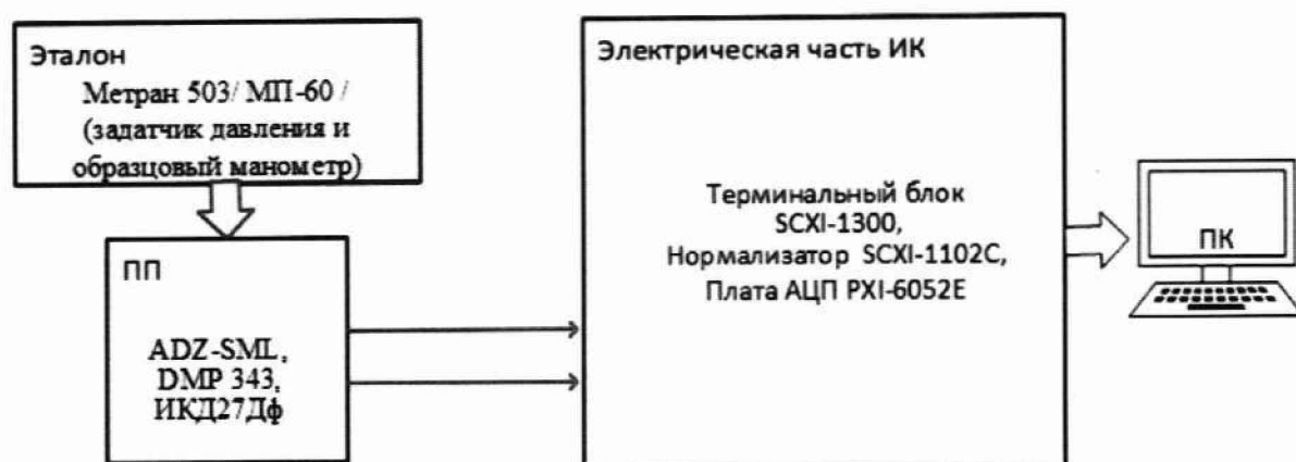
Рисунок 4 – Схема поверки ИК избыточных и разности давлений комплектным способом
