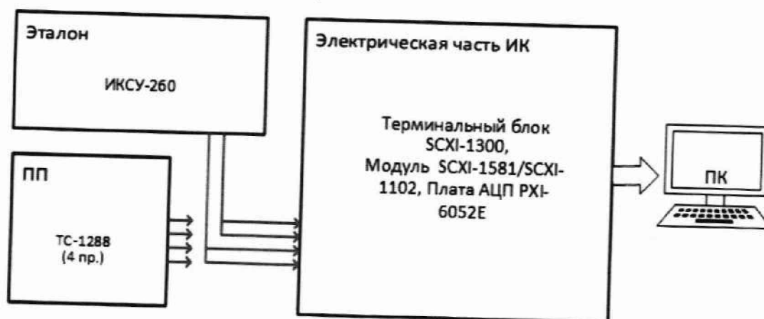
Рисунок 8 – Схема поверки ИК температуры жидких и газообразных сред с ПИП терморезистивного типа (термометров сопротивления) поэлементным способом
