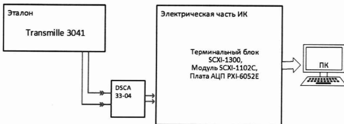
Рисунок 11 – Схема поверки ИК фазового напряжения в цепи нагрузки генератора переменного тока
