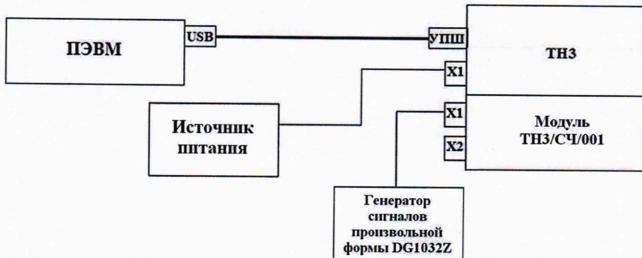
Рис. 1 - Схема соединения модулей ТНЗ/СЧ/001
