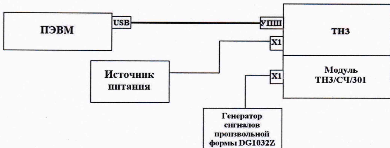
Рис. 2 - Схема соединения модулей ТНЗ/СЧ/301
