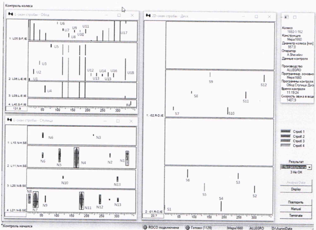
Рисунок 1 – Результат контроля меры ВМТ УЗК-КЛ-01 с обозначением всех моделей дефектов
