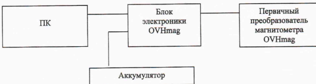
Рисунок 1 - Схема подключения магнитометра OVHmag
