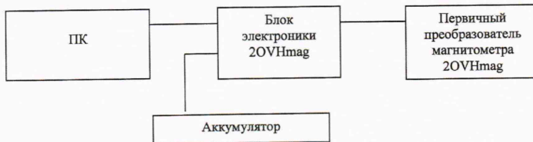
Рисунок 2 - Схема подключения магнитометра 2OVHmag
