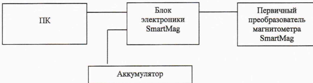
Рисунок 3 - Схема подключения магнитометра SmartMag
