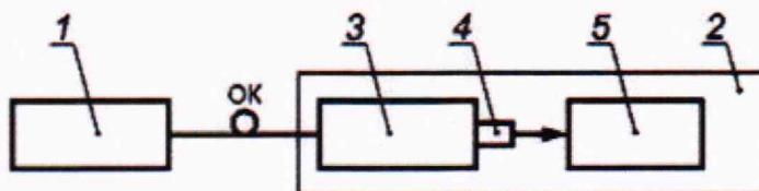
1 – испытываемая платформа; 2 – спектральная установка РЭСМ-ВС (СУ); 3 – монохроматор; 4 – фотоприемное устройство; 5 – регистратор, ОК – оптический кабель
