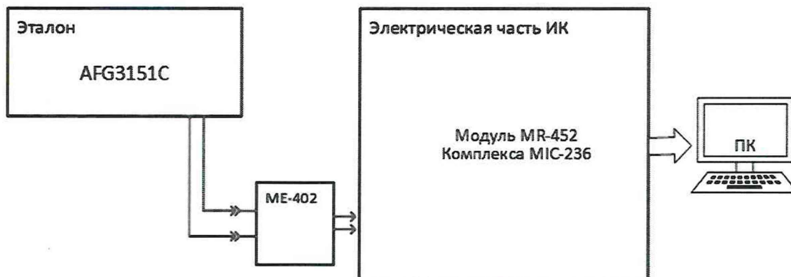
Рисунок 2 – Схема поверки ИК частоты вращения валов двигателя
