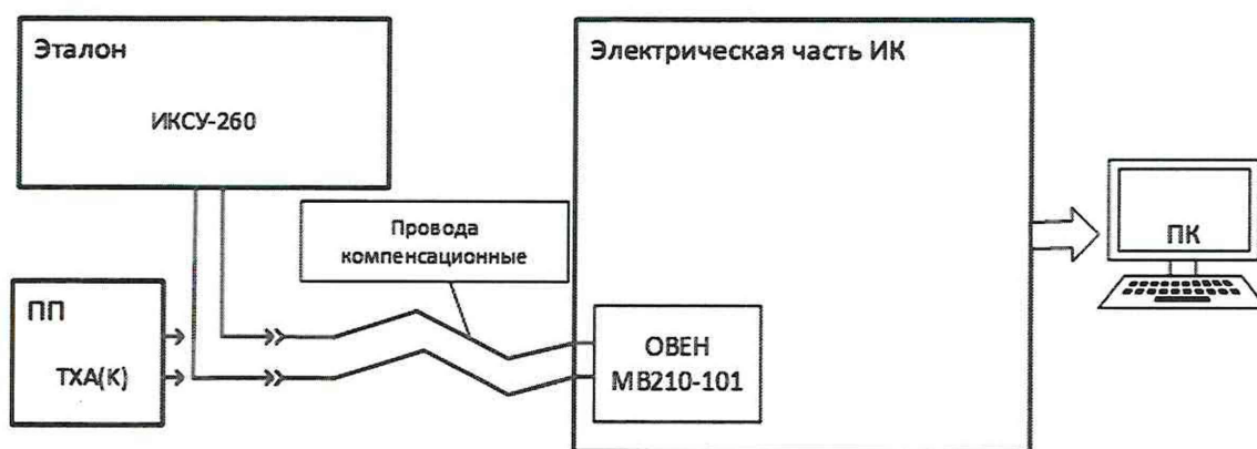
Рисунок 6 – Схема поверки ИК температуры в диапазоне преобразования ПИП термоэлектрического типа
