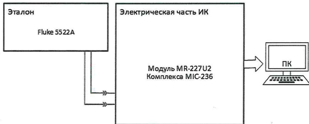
Рисунок 1 – Схема поверки ИК напряжения постоянного тока
