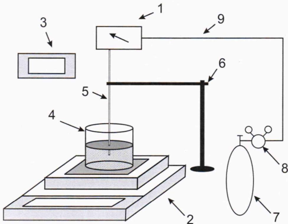
Рисунок 1 – Схема соединений при определении действительного значения расхода жидкости.
