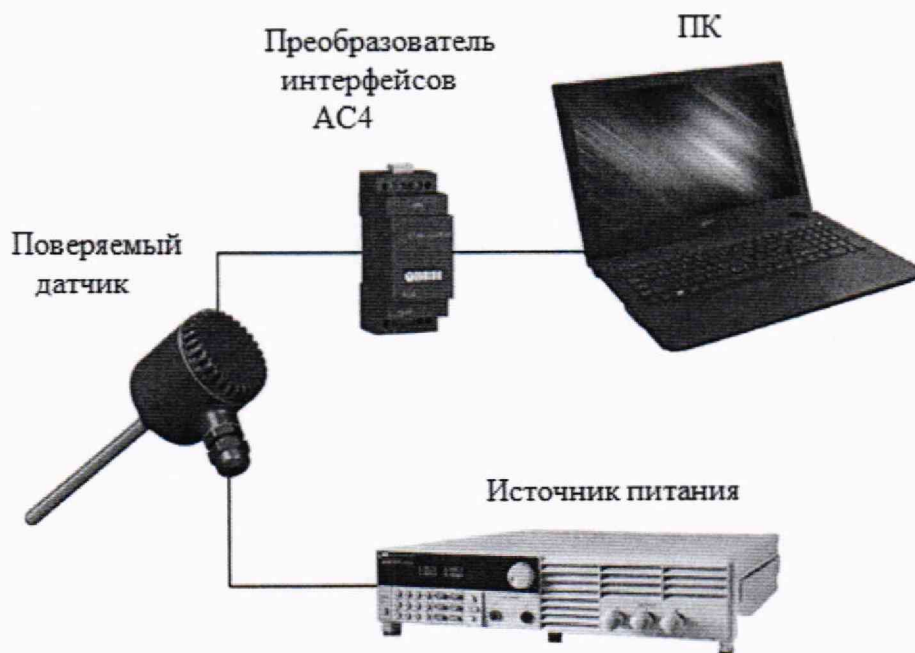
Рисунок 1 – Схема подключений для подачи напряжения питания датчика и подключения к ПК
