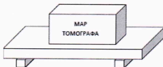
Рисунок 3. Установка МАР томографа на меры МБ1, МБ2.
