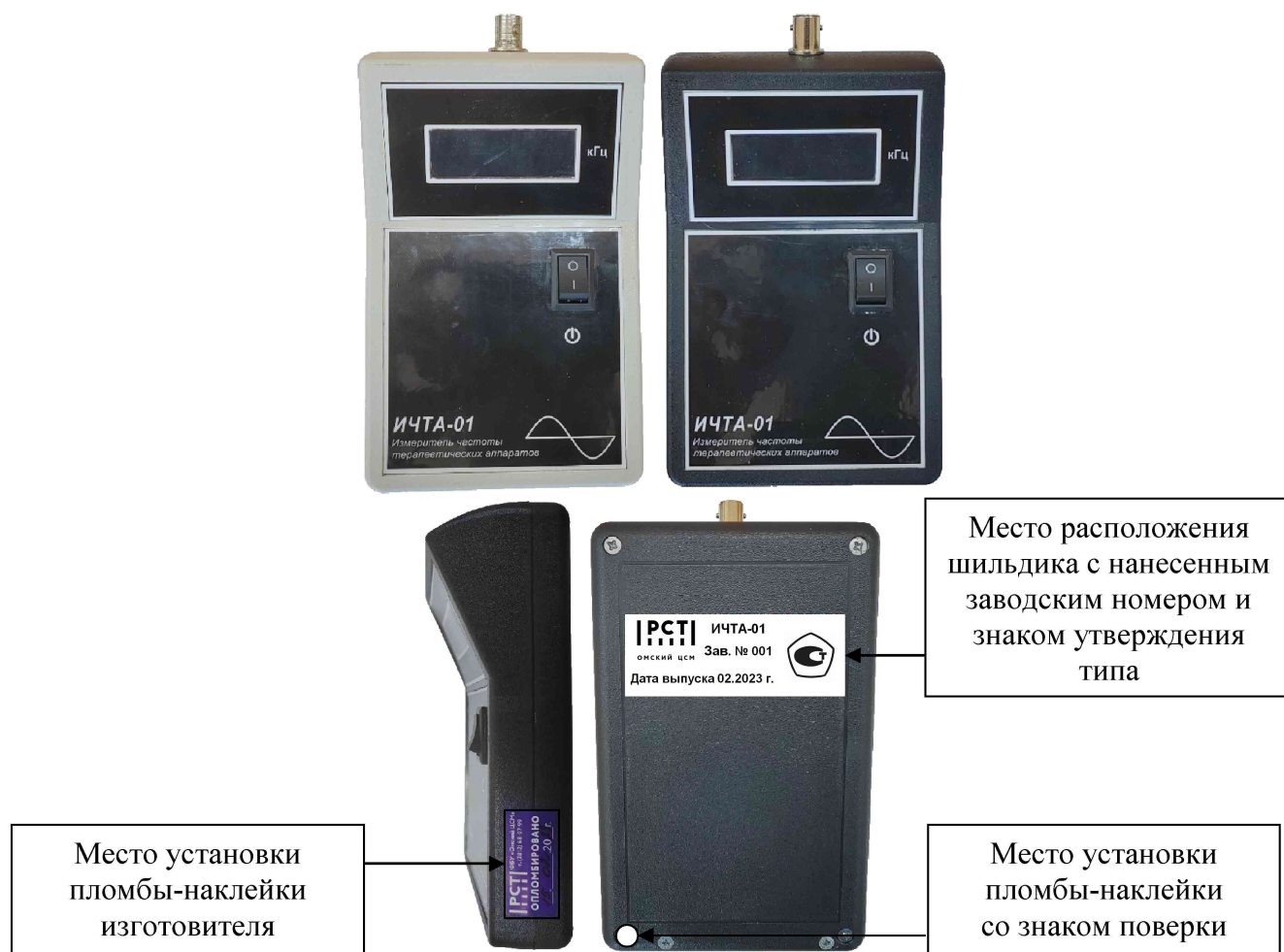
Р и с у н о к 1 – Общий вид измерителей с указанием места расположения шильдика с нанесенным заводским номером и знаком утверждения типа, места установки пломбы-наклейки изготовителя и места установки пломбы-наклейки со знаком поверки
