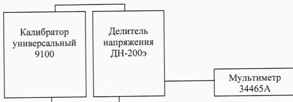
Рисунок 3 - Схема измерений напряжения переменного тока частотой 150 Гц
