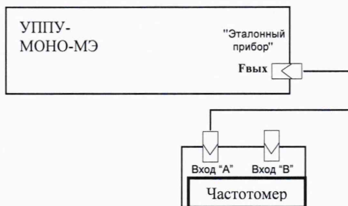
Рисунок 5 - Схема подключения для определения основной погрешности воспроизведения частоты следования импульсов
