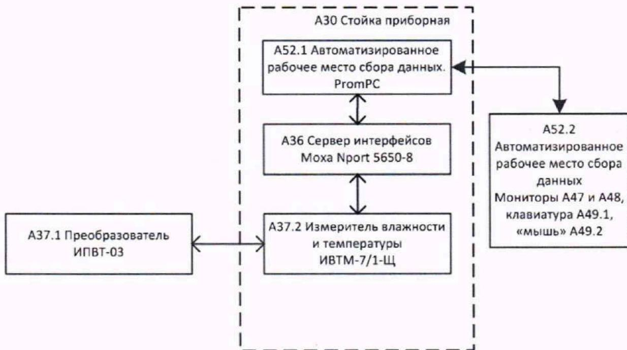
Рисунок 30 – Схема ИК температуры и влажности атмосферного воздуха
