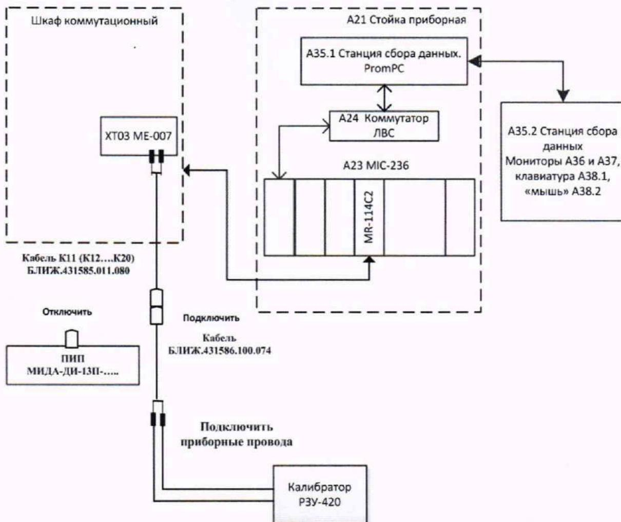
Рисунок 21 - Схема поверки ИК давления жидкостей и газов
