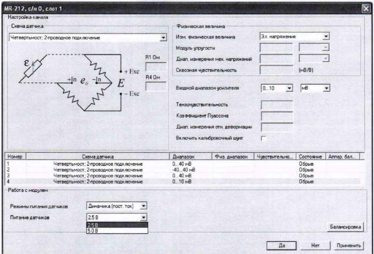
Рисунок 17 – Окно настройки канала модуля MR-212
