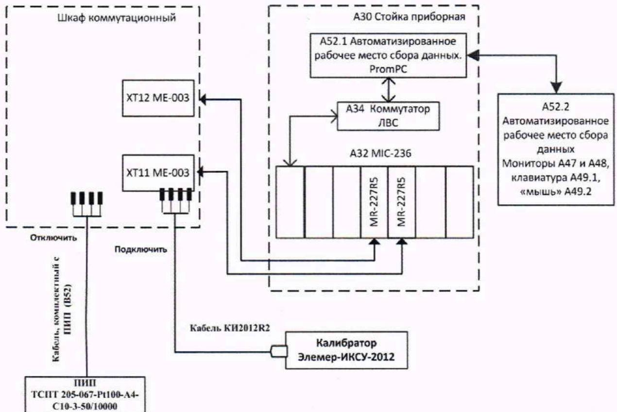
Рисунок 24 - Схема проверки электрической части ИК «Температура воздуха на входе в двигатель, Т<sub>ввхд</sub>» в диапазоне преобразования ПИП терморезистивного типа
