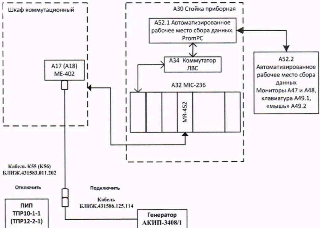
Рисунок 20 - Схема поверки ИК объёмного расхода (прокачки) охлаждающей жидкости и масла
