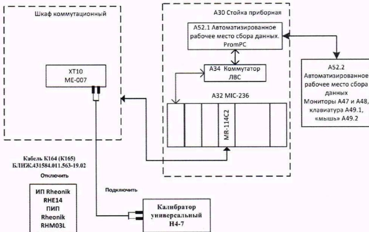
Рисунок 19 – Схема поверки ИК массового расхода топлива
