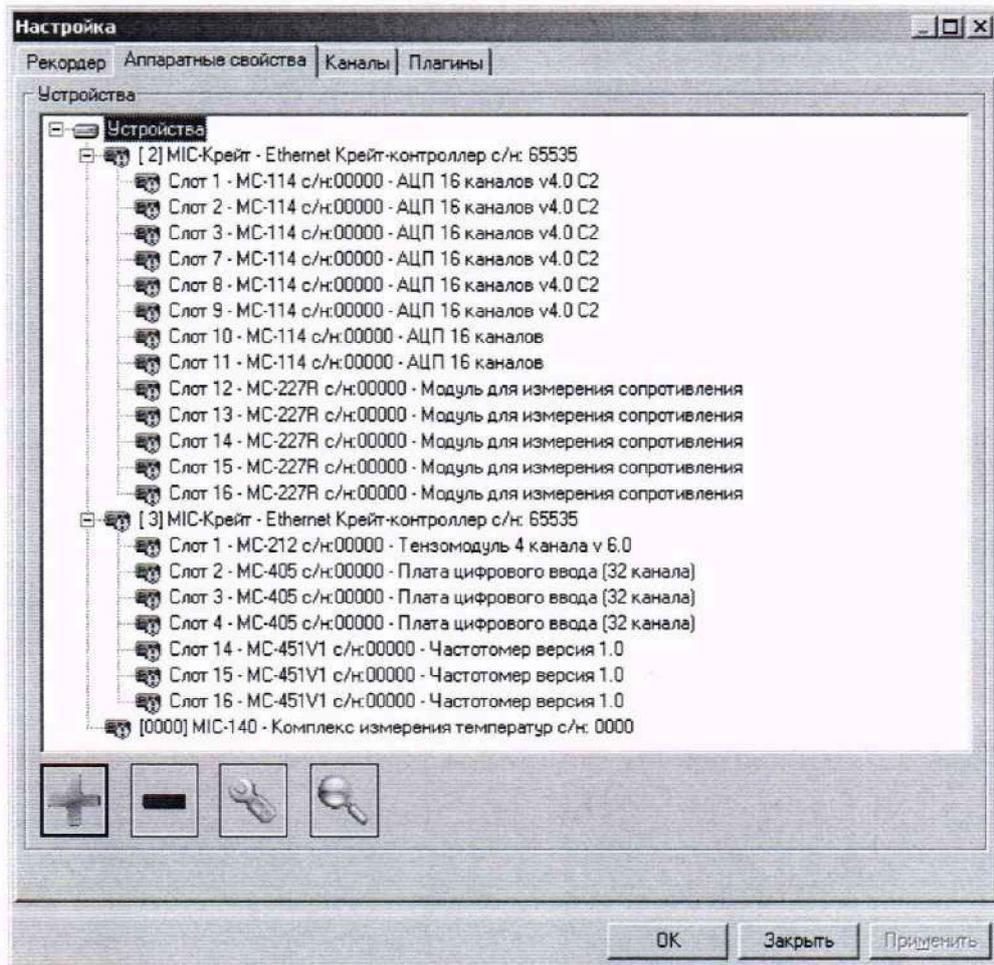
Рисунок 5 - Окно выбранного состава аппаратных средств АИИС ПД200.
