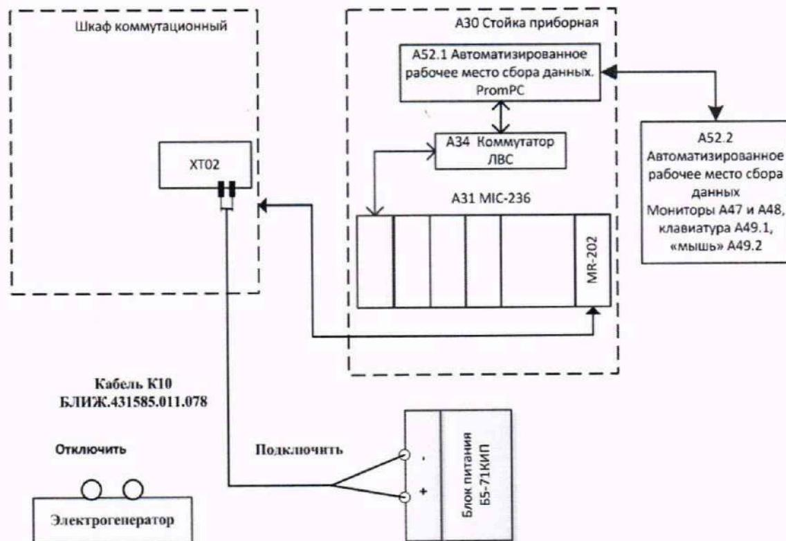
Рисунок 27 – Схема поверки ИК напряжения постоянного тока
