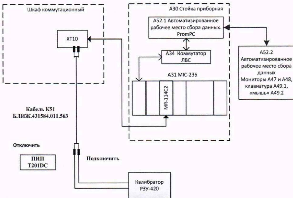
Рисунок 28 – Схема поверки электрической части ИК тока в силовой цепи (цепь питания ЭР)  $I_{сц}$
