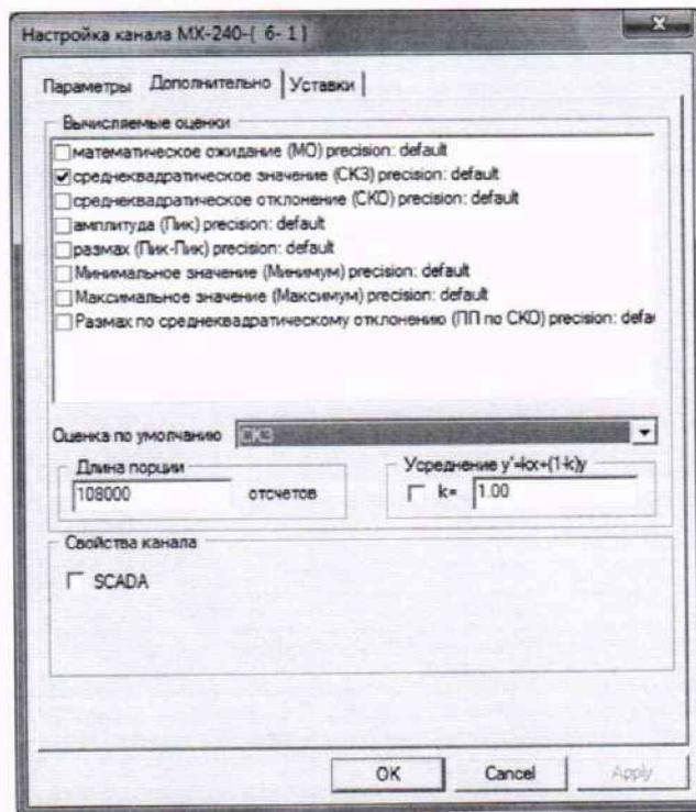
Рисунок 12 – Вид вкладки «Дополнительно» окна «Настройка канала...»
