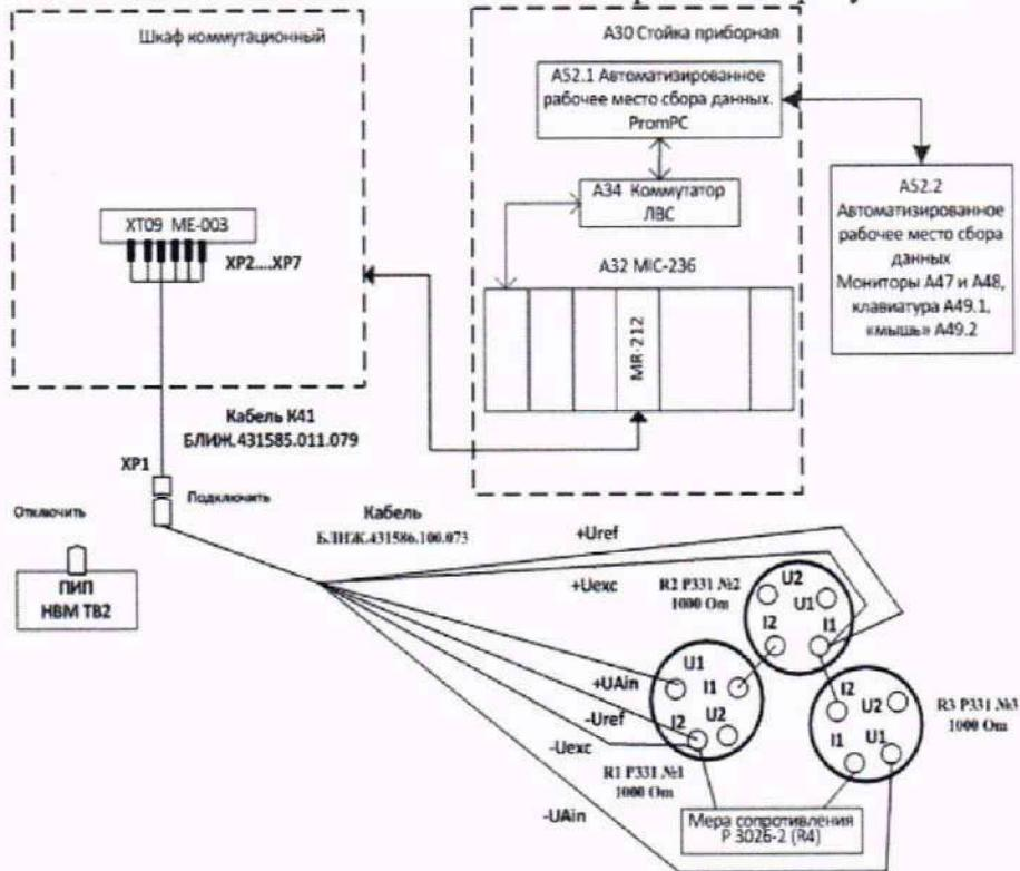
Рисунок 16 – Схема поверки ИК крутящего момента силы
