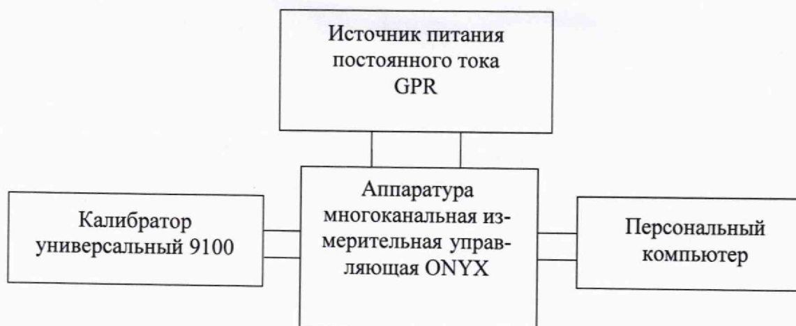
Рисунок 6 – Схема подключений для определения относительной погрешности преобразований выходных аналоговых сигналов силы постоянного тока в значения относительной влажности
