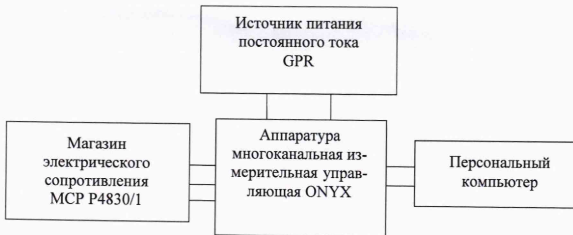
Рисунок 7 – Схема подключений для определения абсолютной погрешности преобразований выходных аналоговых сигналов электрического сопротивления постоянному току от термопреобразователей сопротивления Pt100 с температурным коэффициентом \alpha = 0,00385^{\circ}\text{C}^{-1} по ГОСТ 6651-2009
