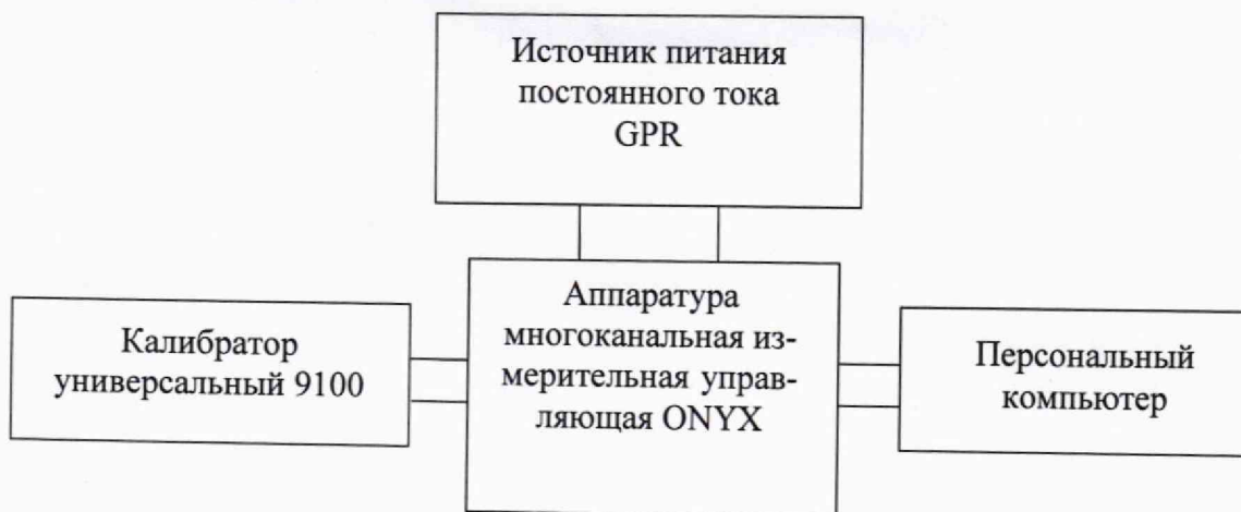
Рисунок 2 – Схема подключений для определения приведенной (к полному диапазону измерений) погрешности измерений напряжения постоянного тока
