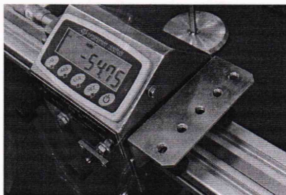
Рисунок 5 – Переходник для крепления стойки отражателя луча системы лазерной измерительной
