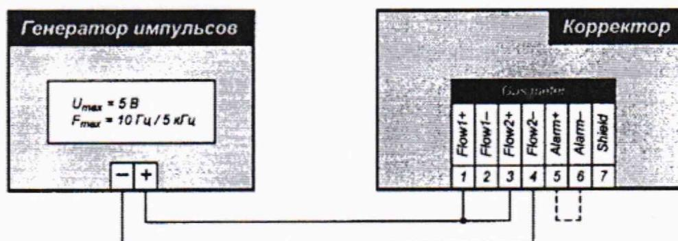
Рисунок 1 – Схема проверки входов счётчика газа
