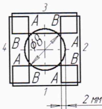
Р и с у н о к 9.3 – Определение отклонения от параллельности плоских измерительных поверхностей
