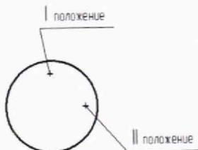
Р и с у н о к 9.4 – Определение перекоса плоской измерительной поверхности микрометрического винта при зажатии стопора микрометра
