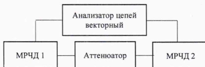
Рисунок 4 – Схема измерения модуля коэффициента передачи  $S_{21}$  ( $S_{12}$ )
