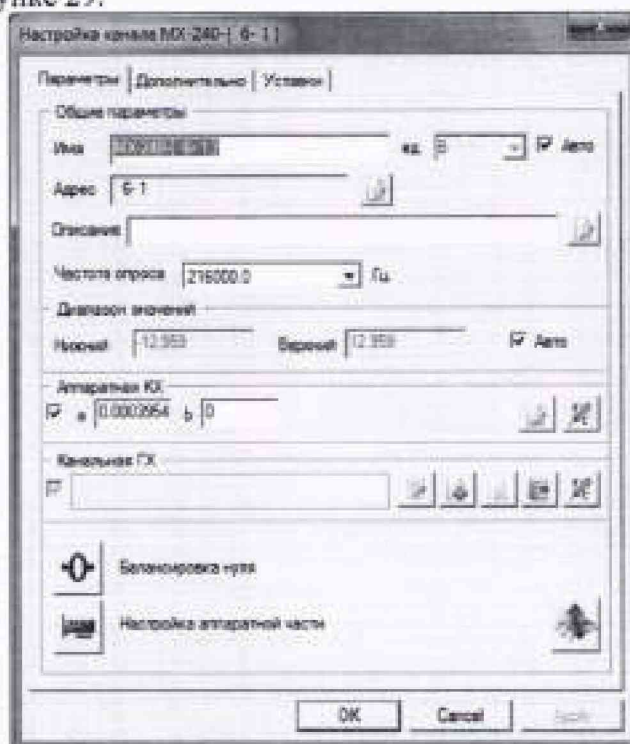
Рисунок 27 – Окно настройка модуля МХ-240
