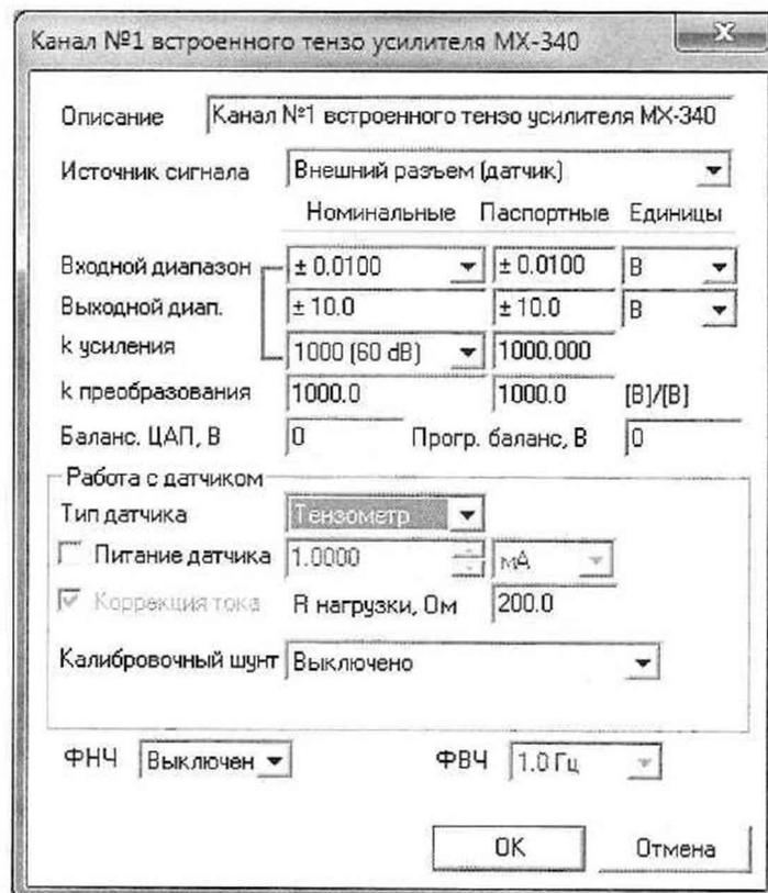
Рисунок 19 – Окно настройки встроенного тензоусилителя ИК МХ-340
