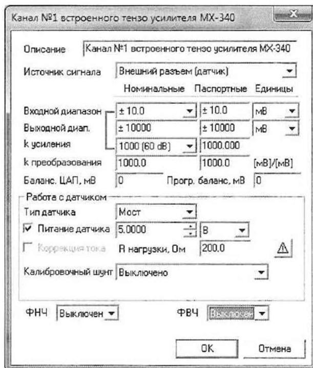
Рисунок 25 - Окно настройки встроенного тензоусилителя модуля MX-340 для проверки ИК напряжения на измерительной диагонали тензометрического датчика
