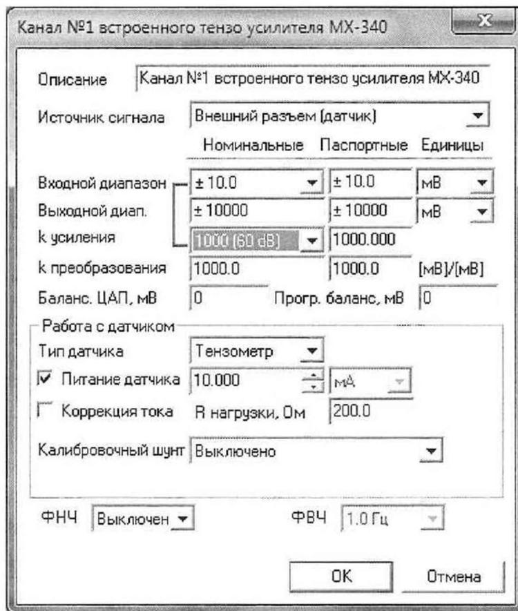
Рисунок 23 - Окно настройки встроенного тензоусилителя модуля МХ-340 для поверки канала питания тензометра током
