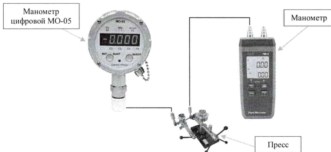
Рисунок 1 – Схема подключений при определении приведенной (к верхнему пределу диапазона измерений) погрешности измерений избыточного давления и приведенной (к верхнему пределу диапазона измерений) погрешности измерений дифференциального давления
