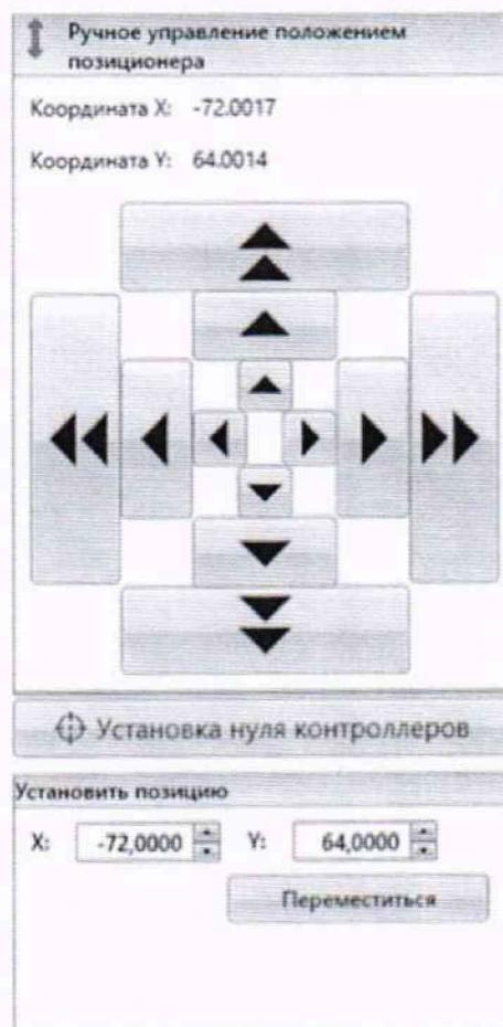
Рисунок 2 – Меню программы для ручного управления движением сканера
