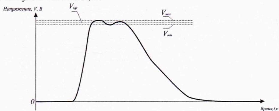
Рисунок 3 – Типовая эпора импульсов напряжения на выходе ИК системы СИИТ-8/20ДНТЭ при входном импульсном сигнале силы тока с длительностью порядка единиц секунд
