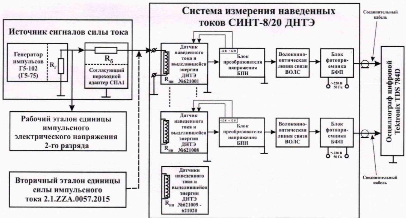
Рисунок 1 – Схема соединений при проведении измерений системы СИИТ-8/20ДНТЭ
