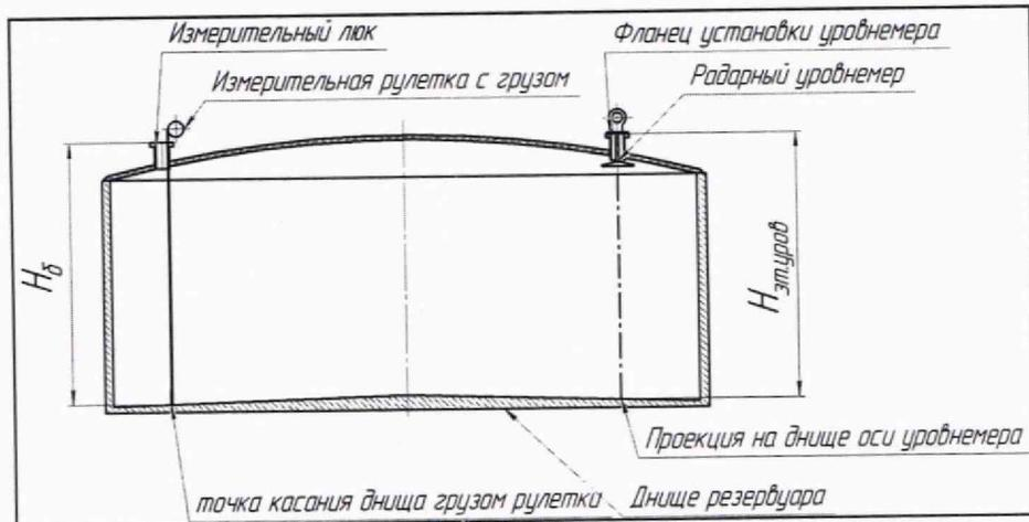
Рисунок А.1 – Схема измерения базовой высоты резервуара и эталонного расстояния урбнмера
