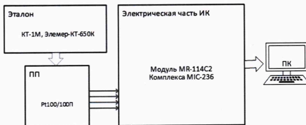
Рисунок 9 – Схема поверки ИК температур с ПИП терморезистивного типа комплектным способом
