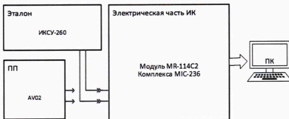
Рисунок 10 – Схема поверки ИК СКЗ виброскорости
