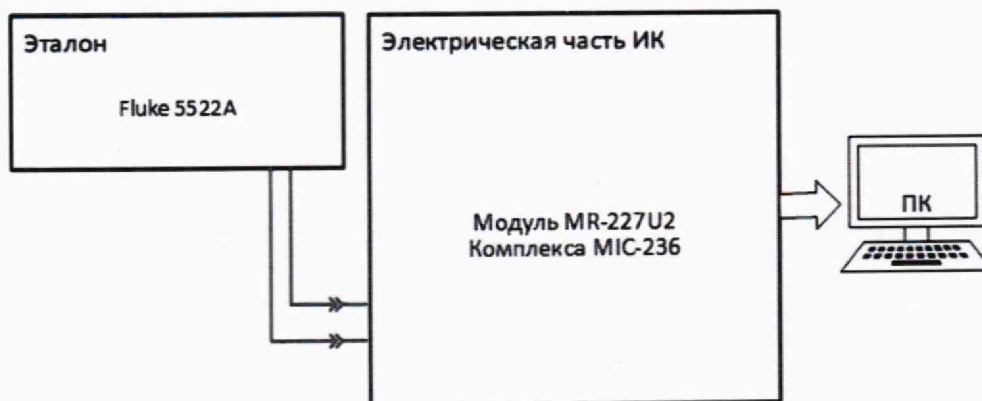
Рисунок 1 – Схема поверки ИК напряжения постоянного тока
