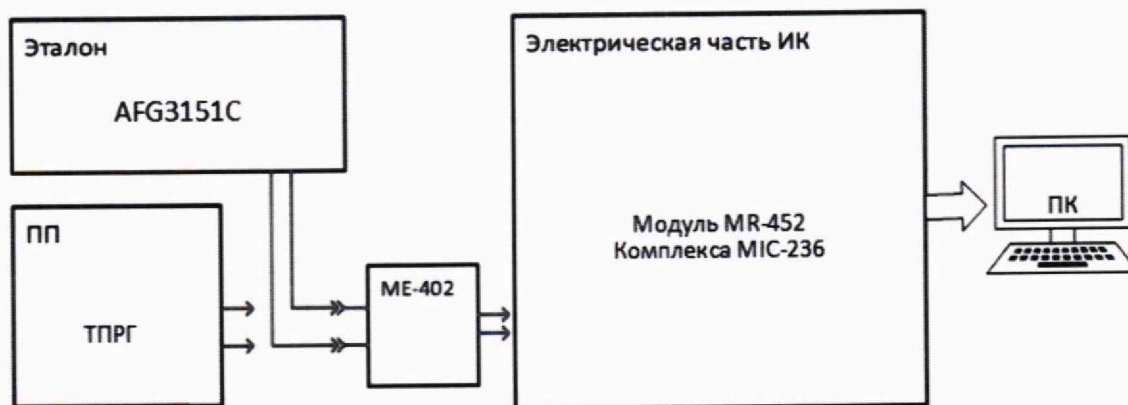
Рисунок 3 – Схема поверки ИК объемного расхода (прокачки) масла
