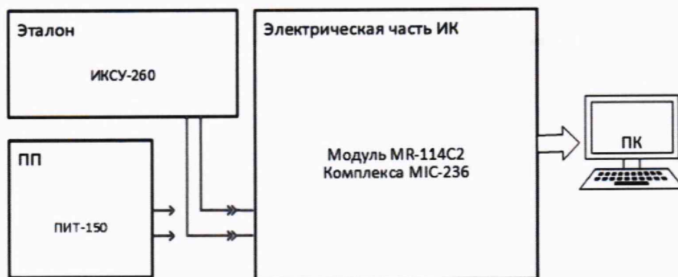
Рисунок 2– Схема поверки ИК силы постоянного тока
