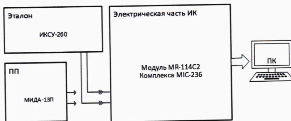
Рисунок 5 – Схема поверки ИК избыточных давлений поэлементным способом
