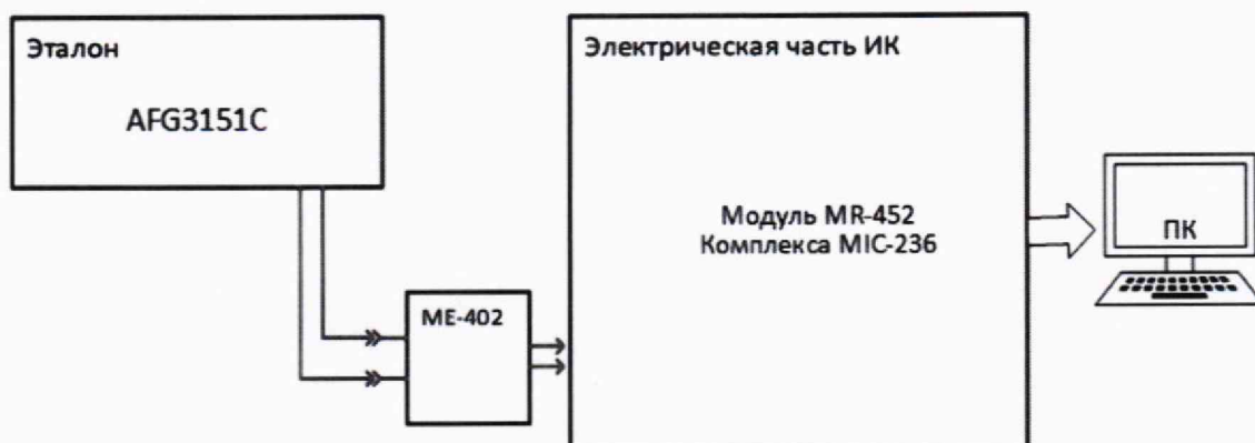
Рисунок 2 – Схема поверки ИК частоты вращения валов двигателя
